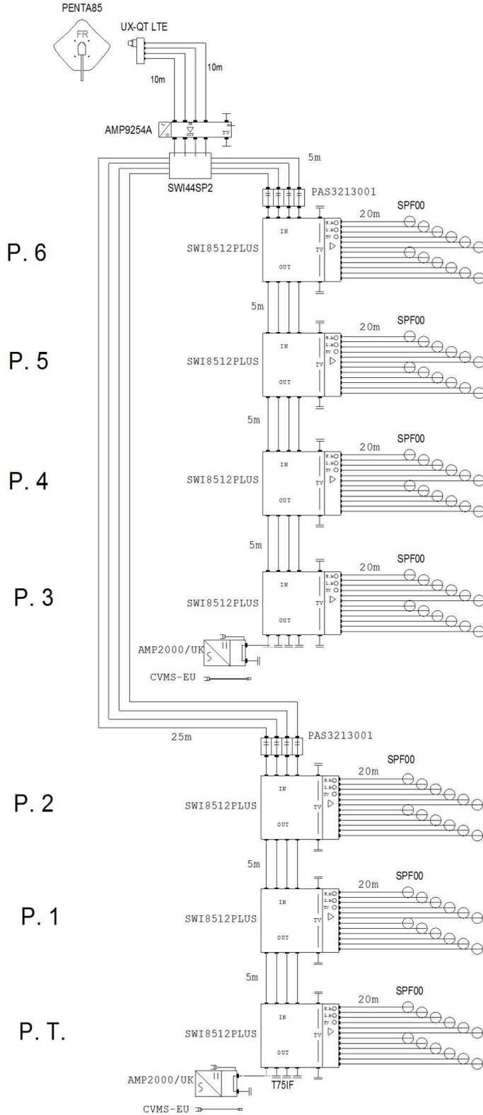
L'Indicazione delle antenne, dei supporti porta-antenna e dei preamplificatori da palo nello schema è puramente indicativa, in quanto la scelta dipende esclusivamente dalla tipologia di segnale TV ricevuto nella zona di realizzazione dell'impianto e dalla struttura dello stabile
